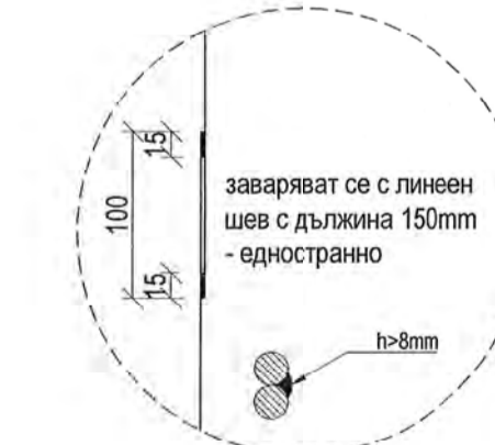
ДЕТАЙЛ "А" ЗА СНАЖДАНЕ СЪС ЗАВАРКА М 1:50
