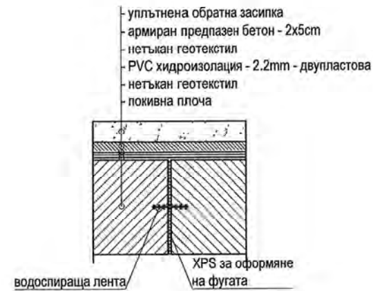
Дилатационна фуга покривна плоча
